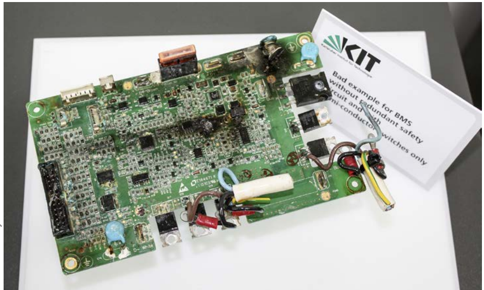
Diese Steuerplatine brannte durch, damit war die Batterie dem Thermal Runaway ausgesetzt.
