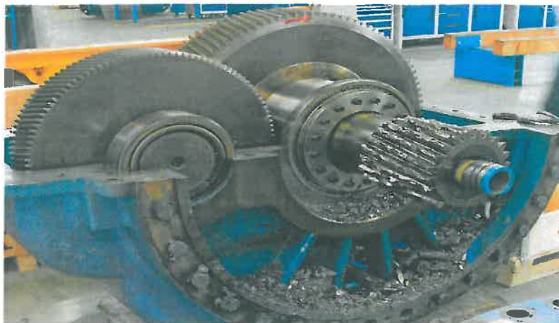
Herausgebrochene Zähne an einem ausgestellten Getriebe.
